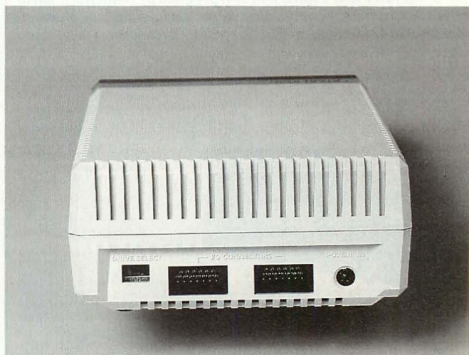
Foto 7 - Il drive 1050 è dotato di switch per l'indirizzamento logico (sulla sinistra della foto) e di due uscite di I/O: la prima per collegarsi al sistema principale, la seconda per realizzare una sorta di rete in serie comprendente un massimo di quattro unità analoghe. Sulla destra la presa per l'alimentatore esterno.
