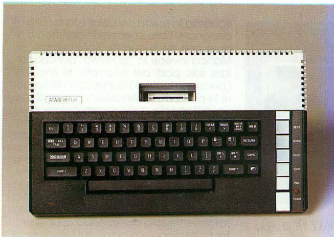
Foto 2 - Al centro, sopra la tastiera, l'alloggiamento per le cartucce con cui sono distribuiti i giochi ed il software. Con l'800XL si possono eseguire tutti i video giochi Atari.
